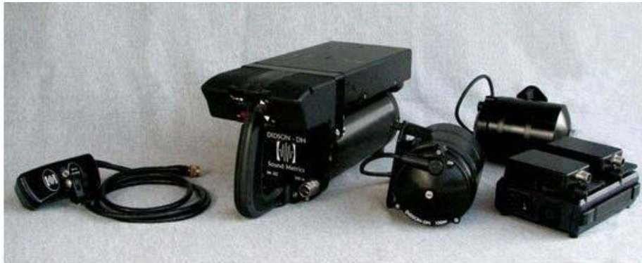
图5 二维实时声呐系统组成
