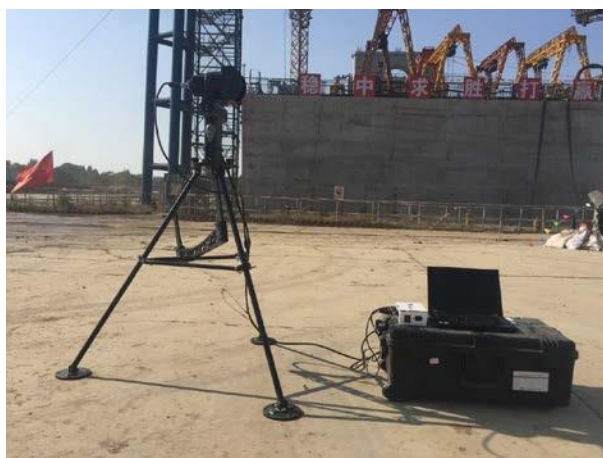
图 3 三维图像声呐系统组成
