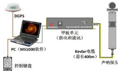
图 1 二维图像声呐系统组成
