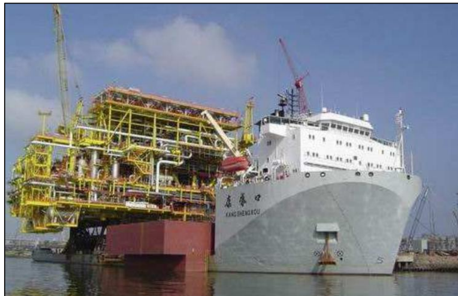
半潜船运输海洋平台上部模块悬垂外飘
